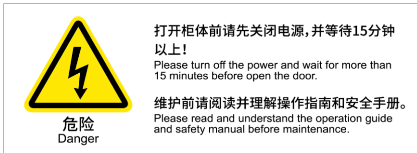
图 1-7 开门断电&维护指示牌
