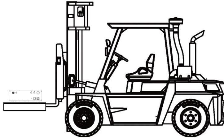
图 2-1 控制柜叉车搬运示意图
